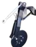
Guida con un disco direzionale centrale.
