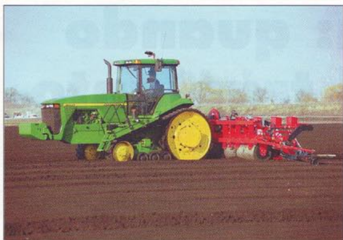
3. Nella semina in pieno campo l'impiego di trattori cingolati in gomma riduce il calpestamento del terreno.
