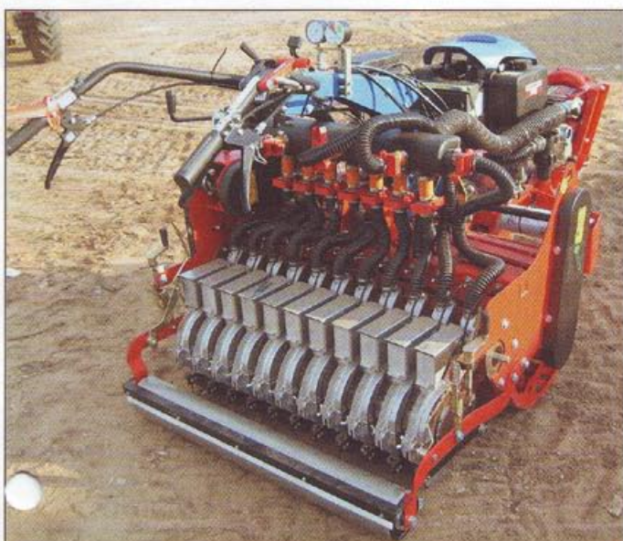
6. Seminatrice pneumatica semovente montata su motocoltivatori, idonea alla semina in serra e su piccoli appezzamenti.
