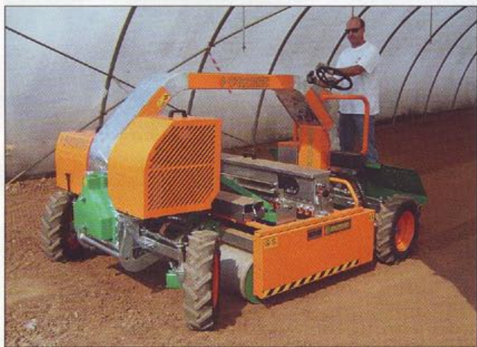
5. L'impiego di porta-attrezzi è particolarmente vantaggioso in serra dove gli spazi di manovra sono ridotti; in associazione alla seminatrice si possono montare altre attrezzature (ad es. pirodiseratrici).
