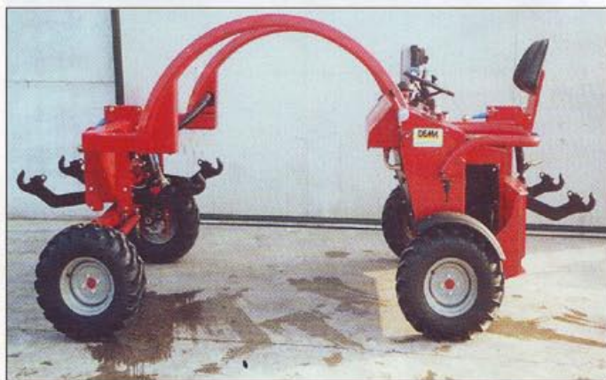
5. L'impiego di porta-attrezzi è particolarmente vantaggioso in serra dove gli spazi di manovra sono ridotti; in associazione alla seminatrice si possono montare altre attrezzature (ad es. pirodiseratrici).
