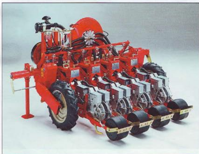
11. Seminatrice con corpi di semina disposti su due ranghi e con tre file di semina per elemento.
