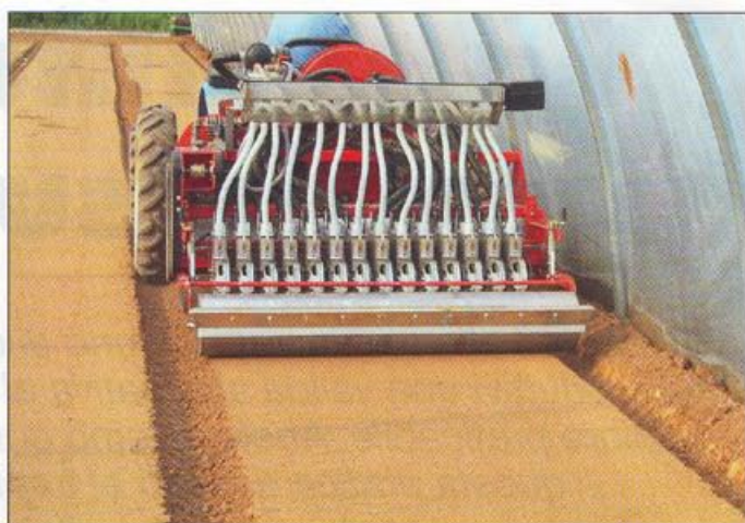
4. La carreggiata del trattore è adattata alla larghezza dell'aiuola di coltivazione in modo tale da creare linee di traffico non interessate dalla coltura adibite al solo passaggio delle ruote.
