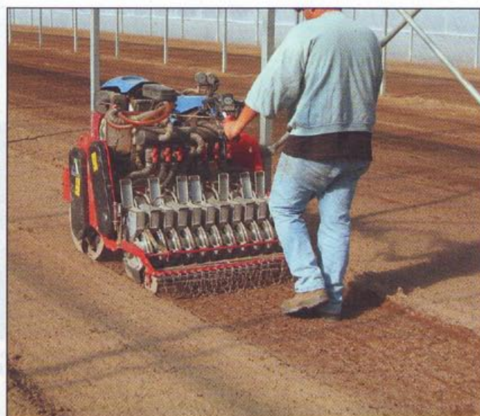
6. Seminatrice pneumatica semovente montata su motocoltivatori, idonea alla semina in serra e su piccoli appezzamenti.
