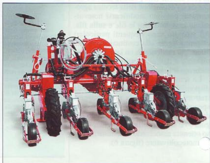
12. Seminatrice per file molto spaziate: la distanza può essere facilmente modificata facendo slittare gli elementi di semina sul telaio.
