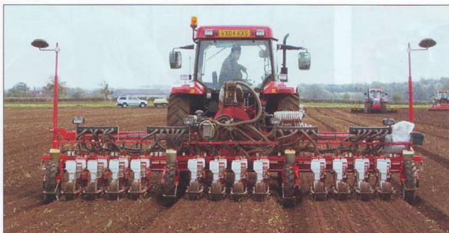
9. Ottimizzazione del costo di esercizio in un'azienda di grande estensione attraverso l'impiego di una seminatrice pneumatica munita di 12 gruppi di semina, per complessive 36 file.
