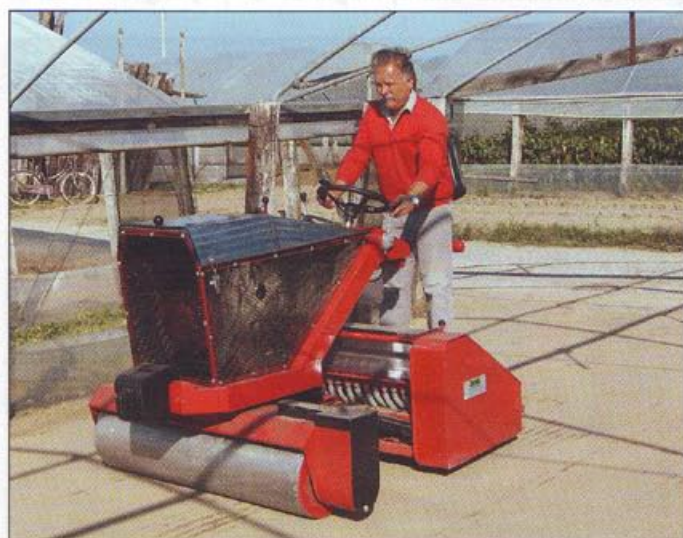
6. Seminatrice pneumatica semovente montata su motocoltivatori, idonea alla semina in serra e su piccoli appezzamenti.
