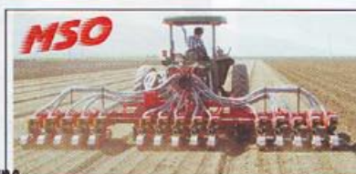
11. Seminatrice con corpi di semina disposti su due ranghi e con tre file di semina per elemento.
