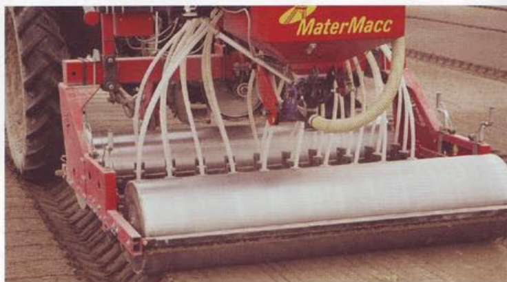
Il rullo posteriore (in questo caso privo di erpicetto) compatta il terreno dopo il passaggio degli elementi di semina.
