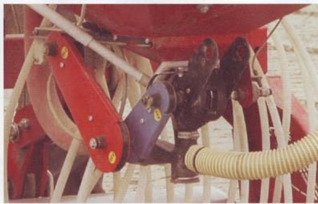
Il dosatore alveolare permette una estrema variabilità nell'impiego del seme.
