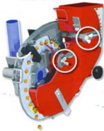
Il disco di semina delle seminatrici Kverneland, dotato di due selettori.
