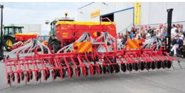
■ MSD 600 per i cereali. L'impiego di 4 ripartitori del seme permette di ridurre l'errore causato dalla diversa pressione che si genera in tubi di lunghezza diversa.
