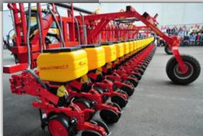
■ La mitica 3XL, nella versione 24 file, è dotata di controlli elettronici che facilitano la gestione delle pressioni sul suolo degli elementi di semina.
