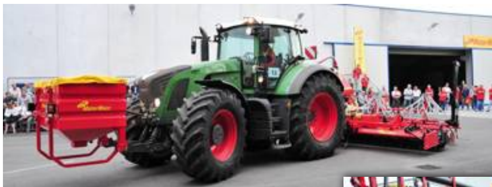
■ Seminatrice combinata ad erpice rotante pieghevole con grande tramoggia anteriore e piccola tramoggia posteriore con funzione di volano.
