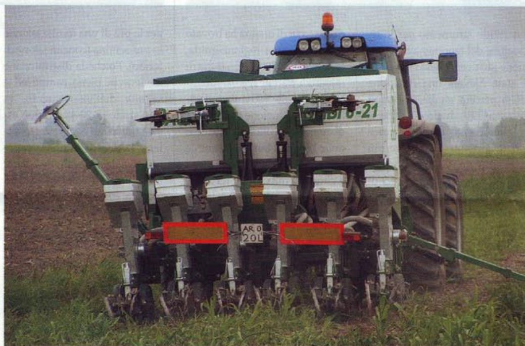
▲ La Baumer Combi 6-21 in versione semina della soia con 6 elementi seminatori a distanza di 45 cm.
