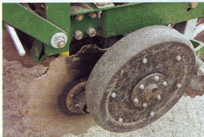
▲ Particolare del disco assolcatore dentato, accoppiato al disco liscio, di diametro inferiore, che si intravede fra i denti del primo.
