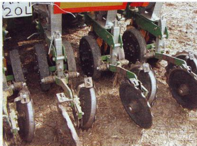
▲ Particolare dell'elemento di semina costituito dall'assolcatore a doppio disco (con due ruote per la regolazione di profondità in gomma) e da un chiudisolco a due ruote dentate e non in asse.
