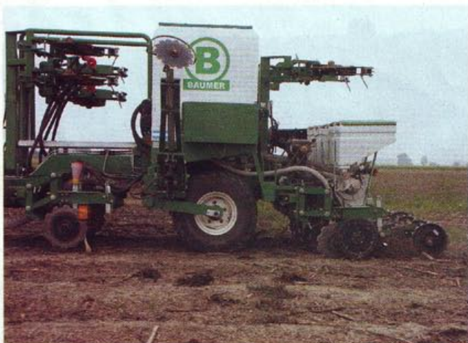
▲ La polivalenza della Combi 6-21 si nota nell'architettura: si usa infatti sia per la semina di precisione che a righe, mentre la tramoggia è adatta per frumento o semi minuti e per il concime.
