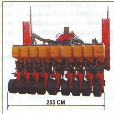
▲ Matermacc X230 9 file con interfila 45-50 cm e ingombro stradale 255 cm.
