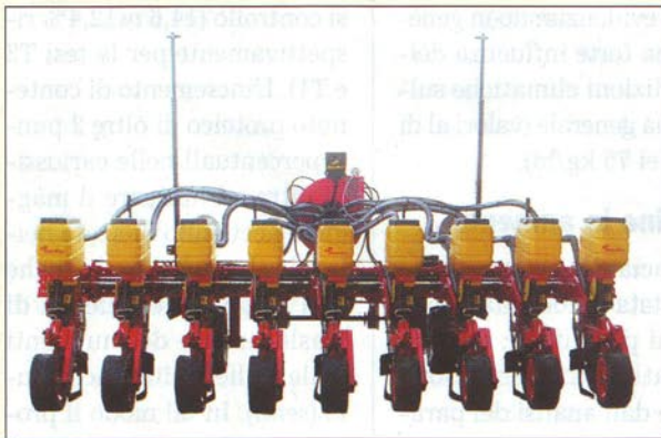
▲ Matermacc X230 9 file con interfila 45-50 cm e ingombro stradale 255 cm.
