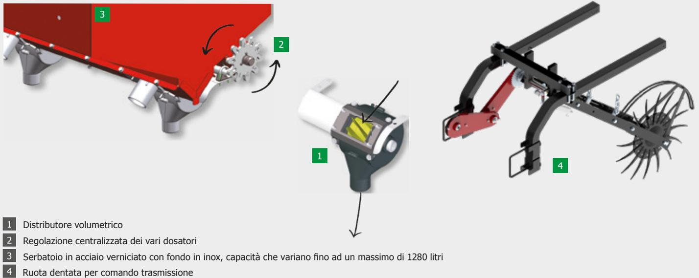
Lo spandiconcime VARIOVOLUMEX è il sistema per caduta gravitazionale del concime sulle file, generalmente a spaglio, per mezzo di tubi flessibili regolabili. Può essere integrato con un sistema pneumatico per il trasporto sulle file più esterne. La regolazione si effettua ruotando la manopola sotto la tramoggia.
