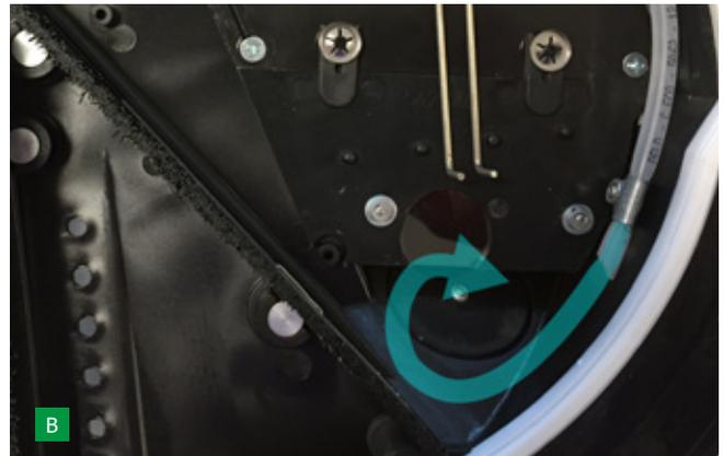
Il distributore di semi MSO, oltre all'aspirazione, utilizza due sistemi di flusso d'aria: il primo per facilitare il distacco dei semi più leggeri dal disco di semina e mantenere i fori puliti da eventuali detriti e residui **A**, il secondo per mantenere i semi agitati sul fondo della camera di carico in modo da facilitarne il pescaggio da parte del disco di semina **B**.
