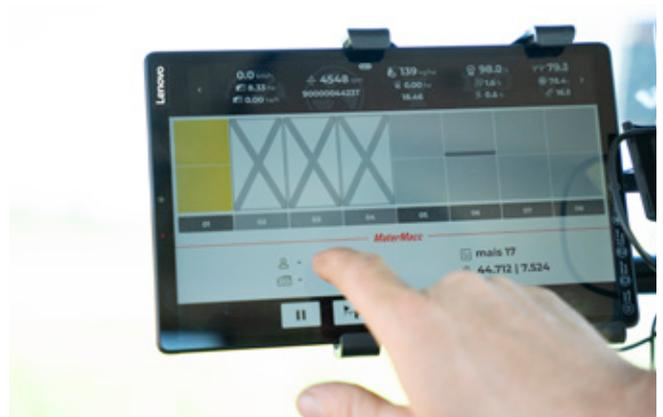
MIPLUS, controllo qualità di semina secondo protocollo standardizzato ISO 7256/1. Grazie all'APP per tablet e smartphone, sia iOS che Android, garantisce semplicità d'utilizzo. Permette di monitorare la qualità di semina delle seminatrici per ortaggi MSO F1 e MSO DUO in tempo reale e per fila, fino ad un massimo di 60 file.
