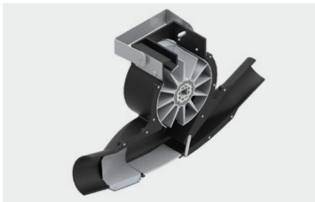
Une option intéressante sur les modèles MS ELEKTRO est la distribution électrique de l'engrais. Comme pour les semences, le boîtier de commande ISOBUS contrôle les moteurs électriques qui actionnent les doseurs. Le bouton de réglage central des doseurs n'est utilisé que pour l'ouverture des trappes ; ensuite, le boîtier de commande contrôle la quantité par hectare selon le dosage pré-réglé.
