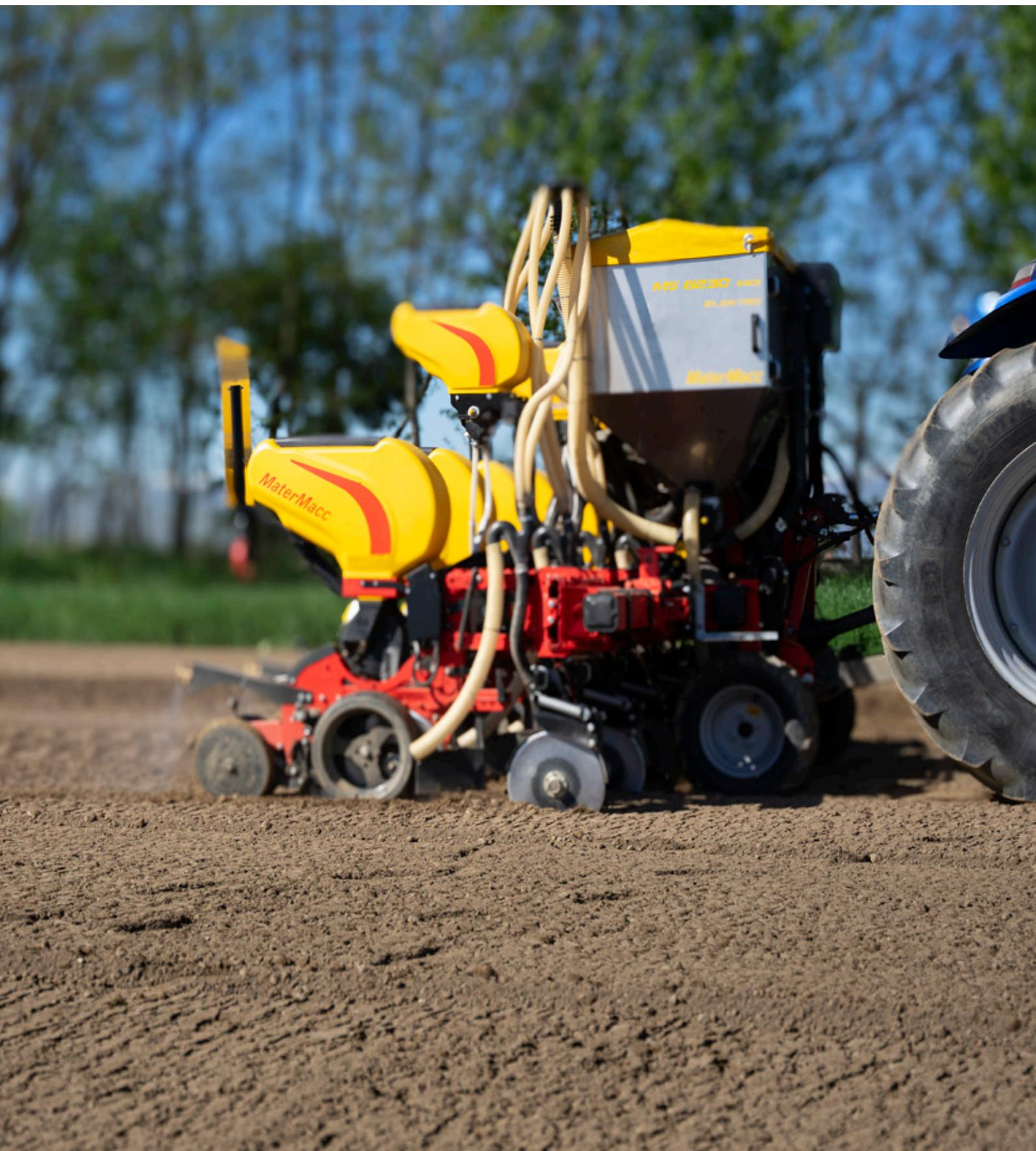
La trémie MIDI est composée de deux doseurs volumétriques qui amènent les granulés d'engrais à chaque rang grâce à un système pneumatique. Le réservoir MIDI a une capacité de 1000 l pour les machines avec un châssis de 2,54 mètres, - de 1.280 l pour les machines avec un châssis de 3 à 3,2 mètres. La trémie MIDI est disponible pour les semoirs MS 8230 et MS 8230 ELEKTRO allant de 6 à 12 rangs..
