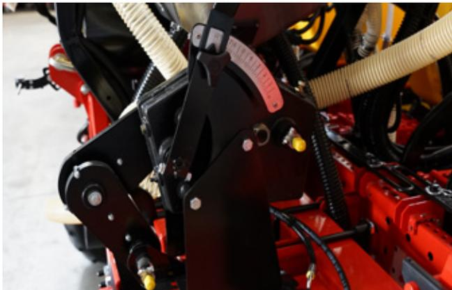
La trémie MIDI se caractérise par le transport pneumatique de l'engrais. Le réglage s'effectue à l'aide d'un régulateur : En actionnant le levier, la quantité peut être calibrée à l'aide des tableaux fournis.
